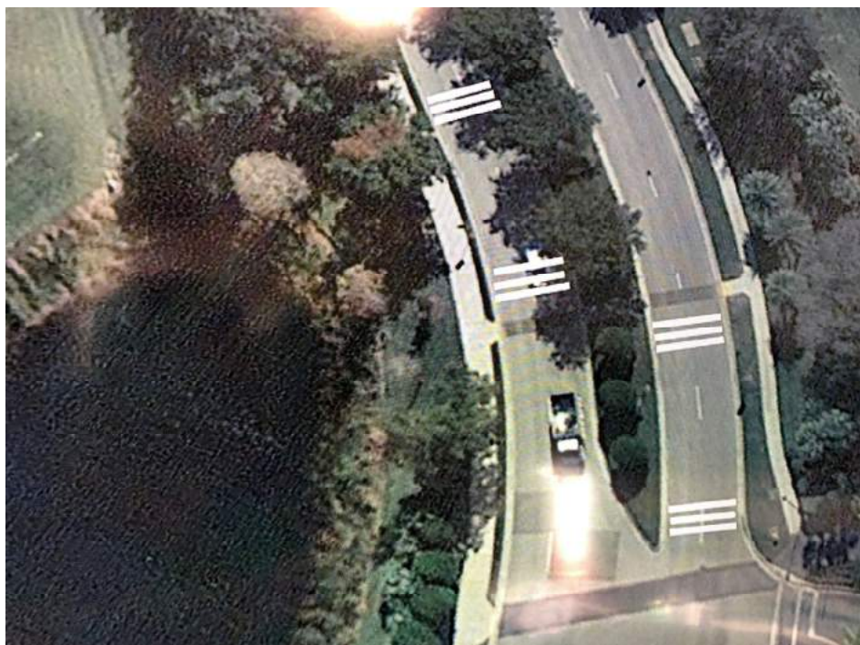
Single Rumble Bar Kit 125 mil 4" base / 250 mil 2" bar
